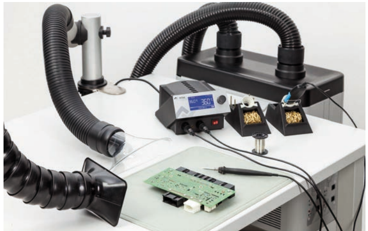
Komplett ausgestatteter i-CON2 VC-Arbeitsplatz mit Lötstation i-CON2 VC, i-TOOL, CHIP TOOL VARIO und Lötrauchabsaugung.
