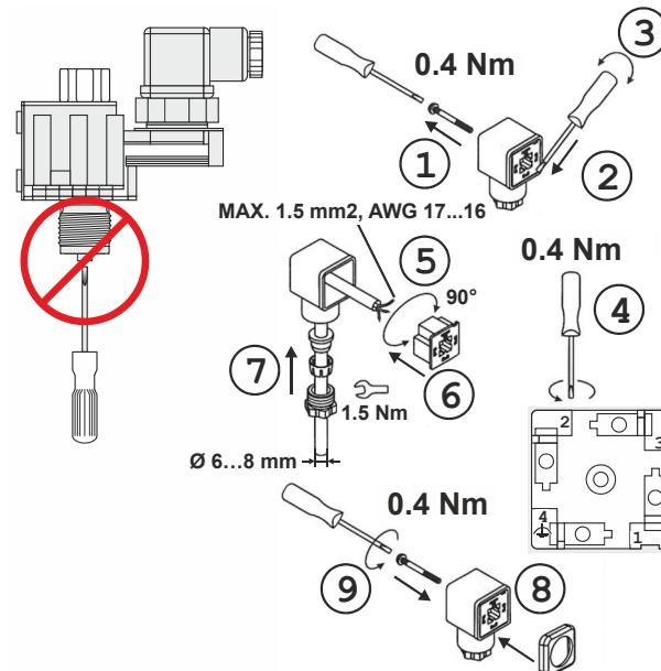
Abb. 4. Anschluß Steckverbinder
